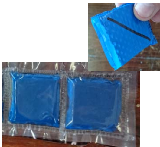
Fig. 1.8 Matricea M-SAC (2017), detaliu S3D îmbibat și capsulat (în ”pungă”)
